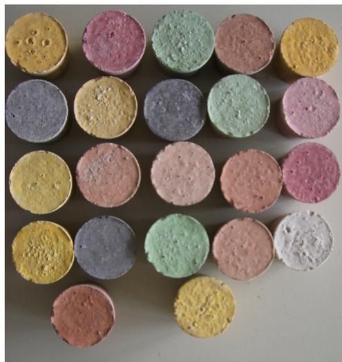
*Bild 5: Farbbeispiele Vorkonfektionierte Trockenspritzbetone*
